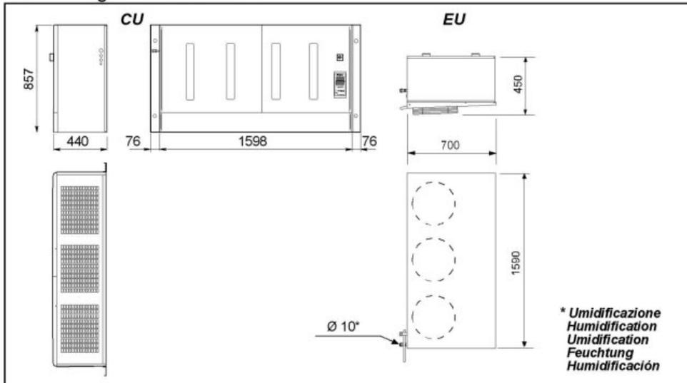
Schema di montaggio - Installation scheme - Schéma de montage
